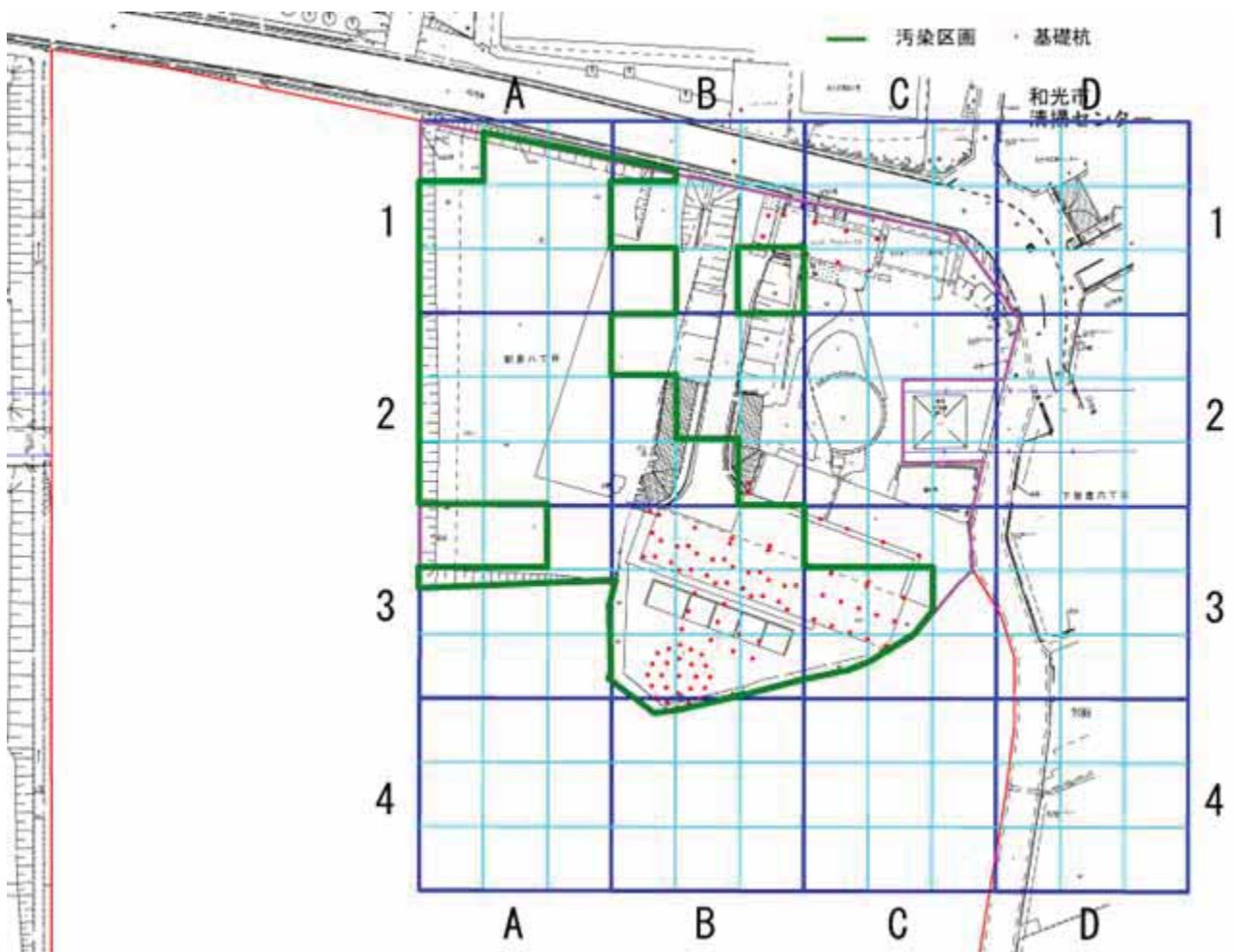
図 2-2 基礎杭残置状況
